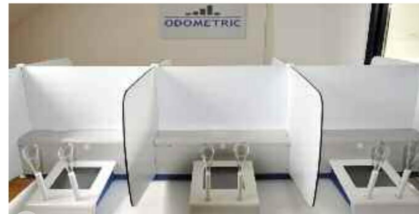
Olfactomètre à dilution dynamique pour mesurer les concentrations d'odeur selon la norme EN13725
